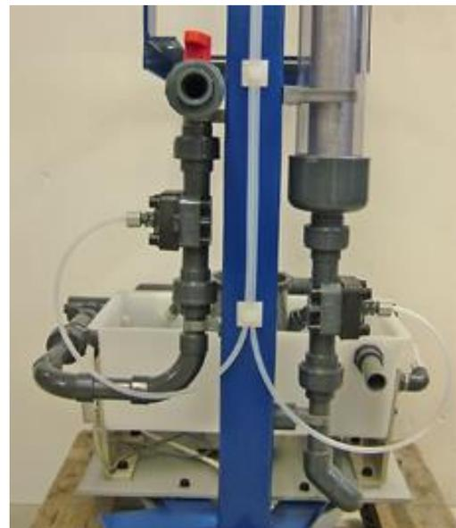
2. Elektromagnetventile: hier werden selbstschließende Ventile von Bürkert eingesetzt, die jedoch nur bis ca. 0,8 bar sicher schließen. Das Absperrventil in der Dosierleitung ist hierbei **umgekehrt zur angegebenen Durchflussrichtung eingebaut**.
